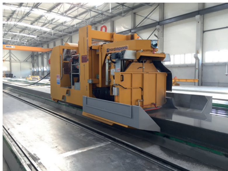
Многоугольная пила для резки пустотных плит толщиной 500 мм
