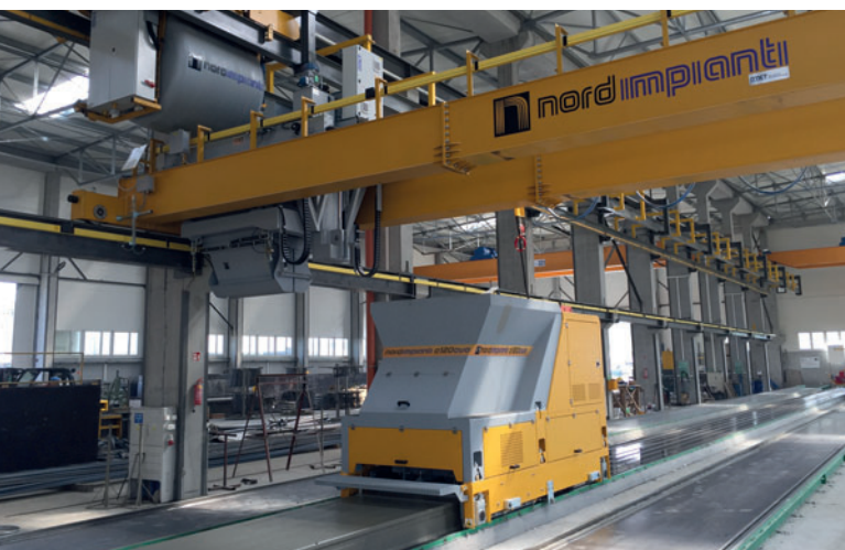
Extrudeuse EVO avec système de distribution de béton entièrement automatique
