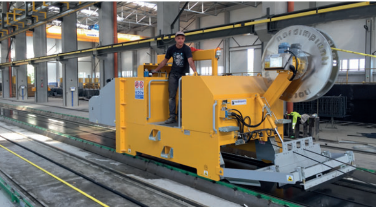
Nettoyant de lit multifonctionnel pour la préparation du lit de précontrainte
