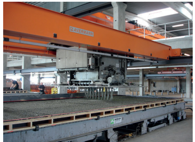
Fig. 5: La station de coulage avec le distributeur de béton et le compacteur à vibrations Avermann
