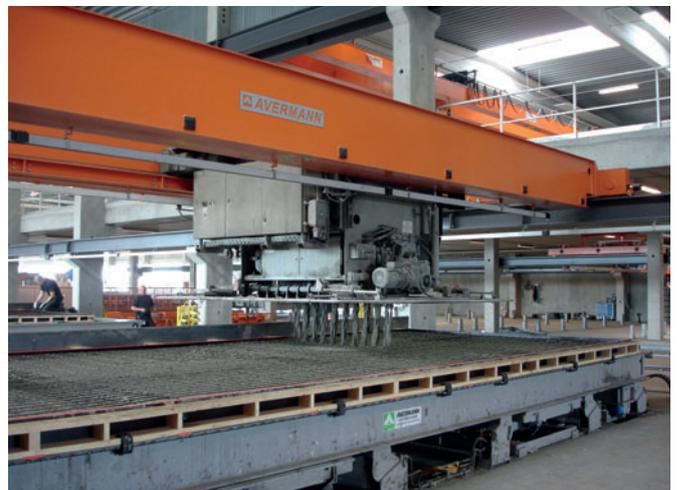
Fig. 5: Estación de hormigonado con distribuidor de hormigón y compactador por vibraciones de Avermann
