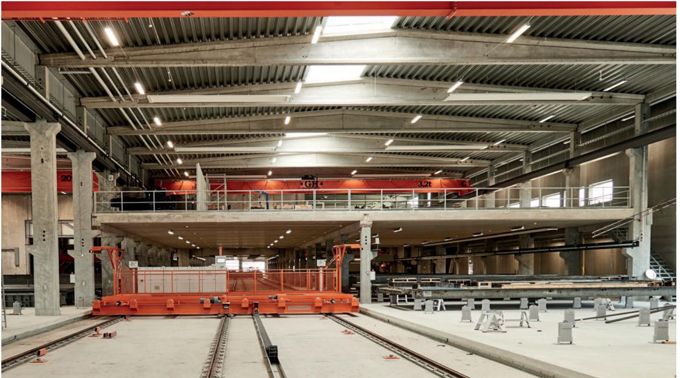
Fig. 3: Transporte de paletas con plataforma de desplazamiento central
