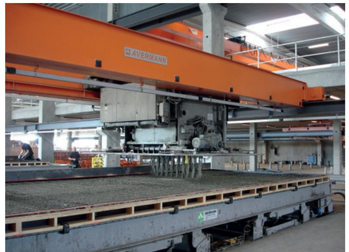
Abb. 5: Betonierstation mit Betonverteiler und Avermann-Schwingverdichter
