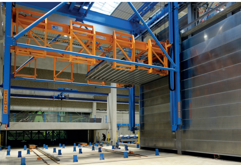
Стеллажный штабелер для обслуживания камер выдержки
