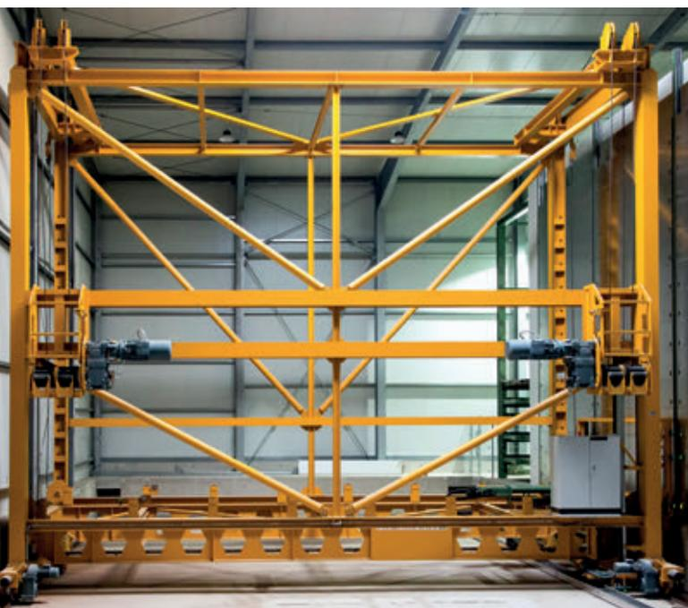
Стеллажный штабелер для погрузки и разгрузки поддонов в камере выдержки
