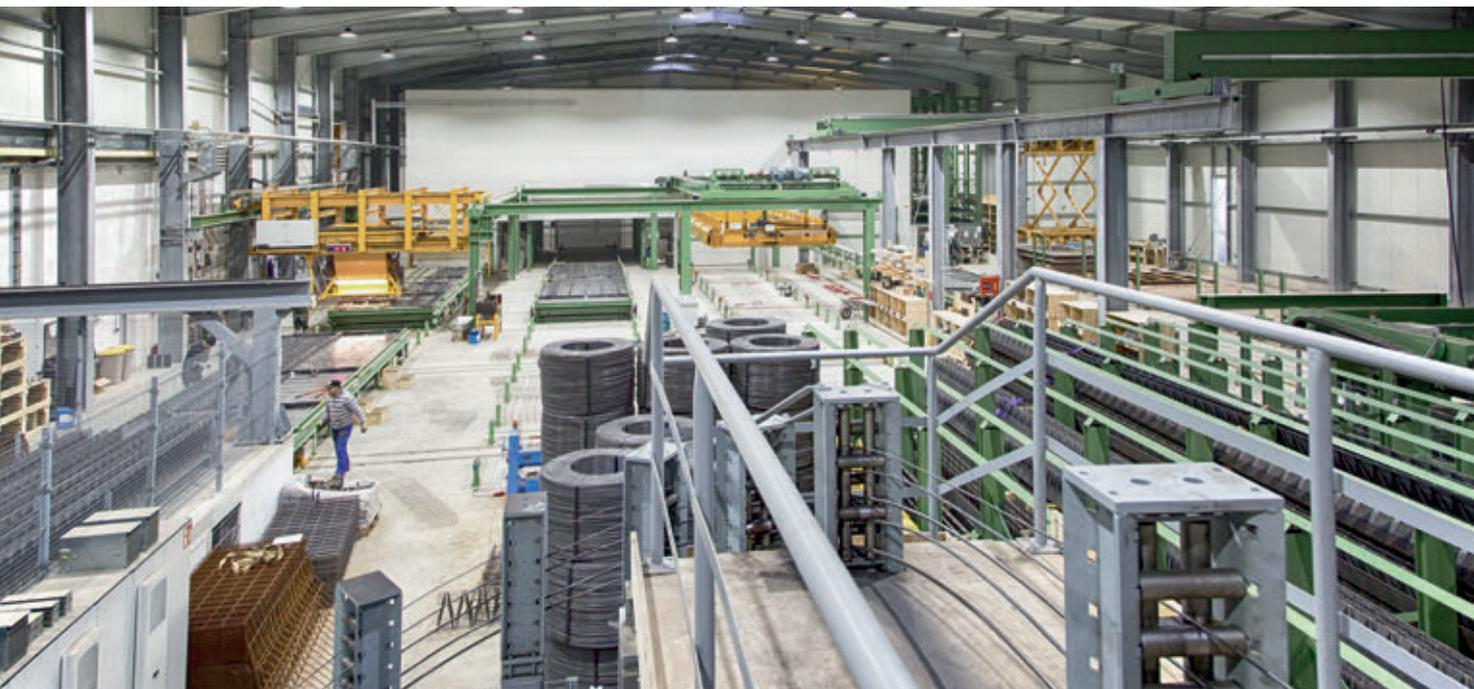
Посты бетонирования, уплотнения, кантования и распалубки на линии оборотных поддонов
