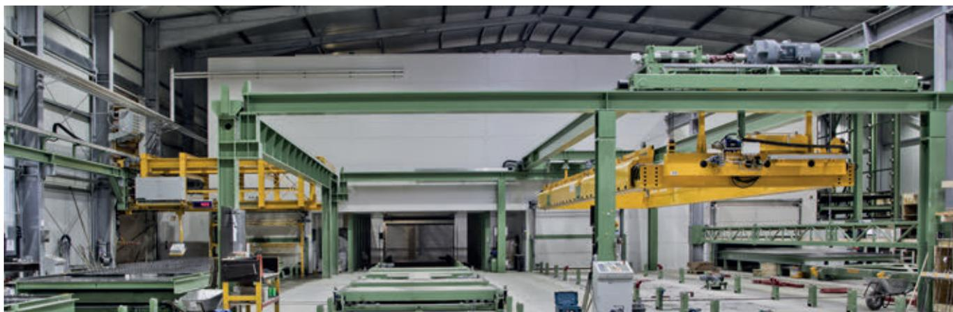
Виброуплотнитель под станцией бетонирования и автоматическим кантователем
