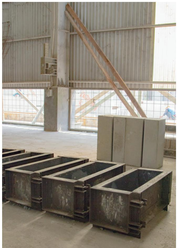
*PT Motive Mulia utiliza el hormigón residual para productos secundarios como bordillos de hormigón que, entre otras cosas, separan la calzada de la acera en la capital Yakarta (detrás). Los moldes de acero para este (delante) fin los construye la propia empresa*
