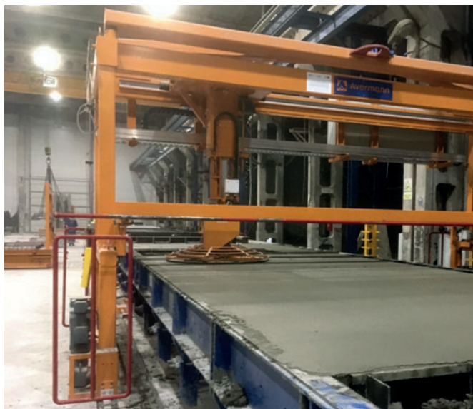
Лопастная затирочная машина в процессе заглаживания поверхности
