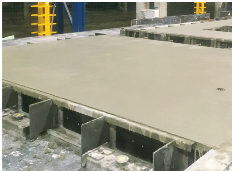
Element betonowy z wygładzoną powierzchnią.
