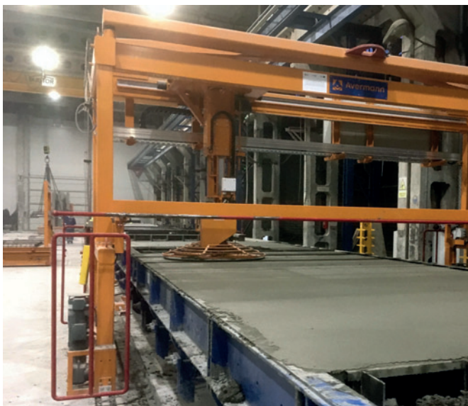
Zacieraczka podczas wygładzania powierzchni betonu.
