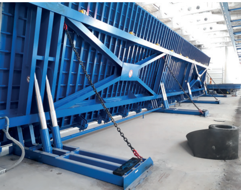
Linia technologiczna ze stołami uchylnymi do produkcji ścian.
