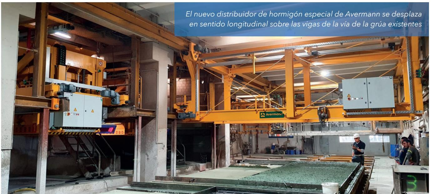
*El nuevo distribuidor de hormigón especial de Avermann se desplaza en sentido longitudinal sobre las vigas de la vía de la grúa existentes*
