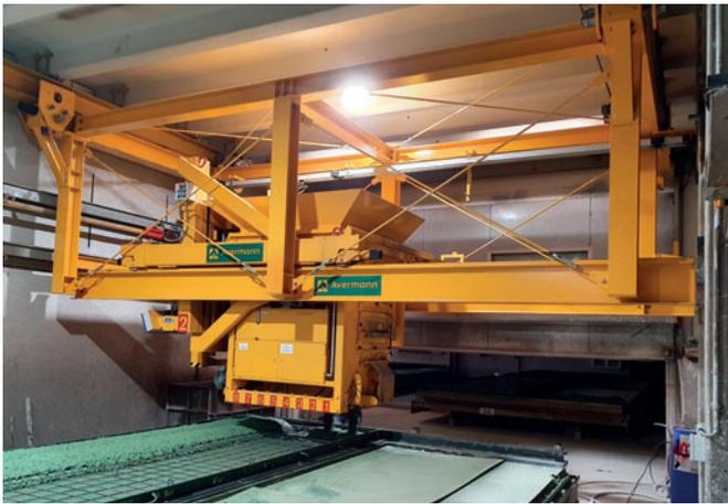
La descarga de hormigón y la dosificación se efectúan mediante ocho correderas con ajuste del ancho de apertura y con un rodillo de descarga situado en el interior de cada cuba
