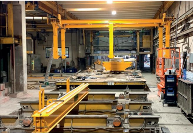
*El montaje tuvo que efectuarse sin ayuda de ninguna grúa, solamente con medios manuales, como polipastos y rodillos para grandes cargas*
