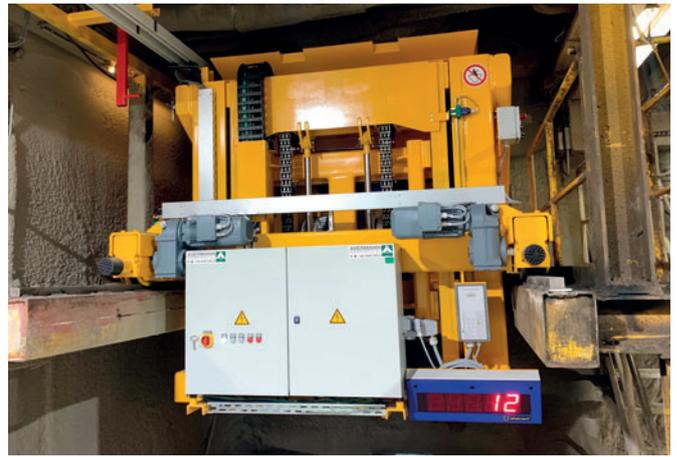
Cada cuba del distribuidor de hormigón cuenta con un armario de distribución que se desplaza al mismo tiempo con control y dispositivo digital de medición del peso con un amplio visor
