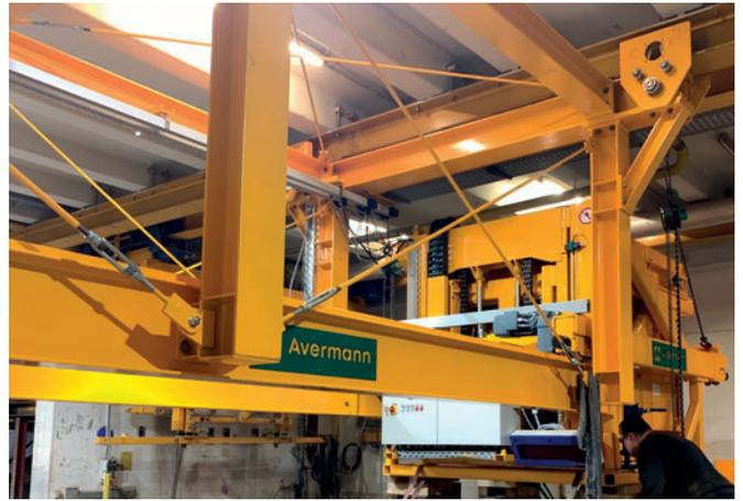
*La altura de elevación de cada cuba de hormigonado es de 1100 mm*
