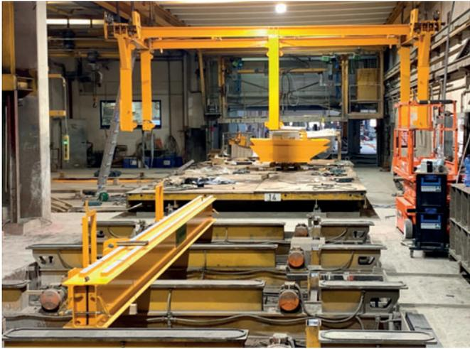
Монтаж производился исключительно с помощью ручных вспомогательных средств, таких как цепные тали и бронированные катки
