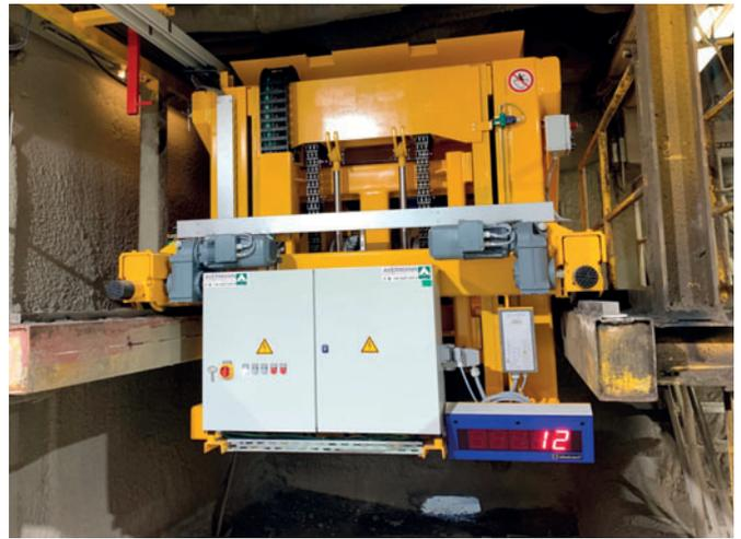
Каждая бадья также оборудована мобильным электрошкафом с системой управления и цифровым весоизмерительным устройством с большим локальным дисплеем
