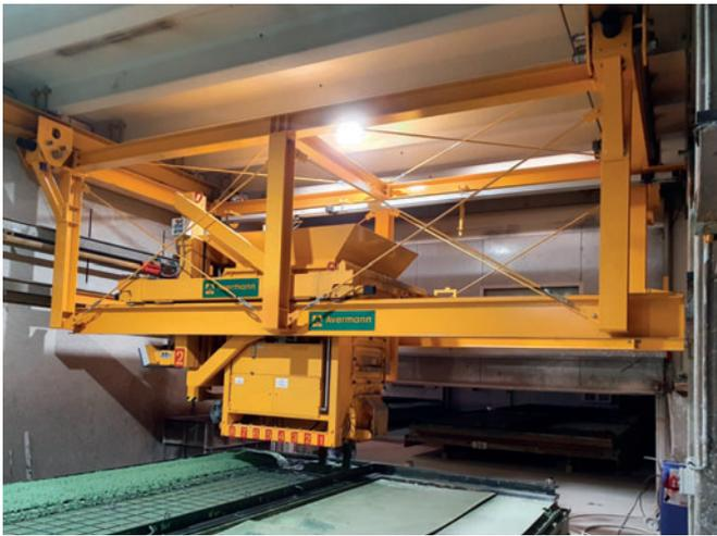
Выгрузка и дозирование бетонной смеси осуществляется с помощью восьми шиберных затворов с регулировкой ширины раскрытия и разгрузочного валика внутри каждой бадьи
