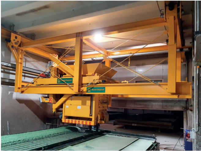
Der Betonaustrag und die Dosierung erfolgen über acht Schieber mit Öffnungsweitenverstellung und mit einer Austragswalze im Inneren eines jeden der beiden Kübel.
