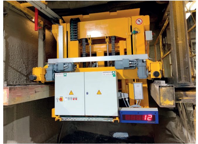
Jeder Betonverteilerkübel ist mit einem mitfahrenden Schaltschrank mit Steuerung und digitaler Gewichtsmesseinrichtung mit Großfeldanzeige ausgestattet.
