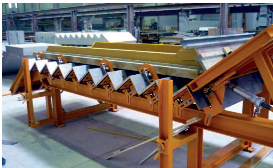
Рис. 2: Изготовление стандартных маршей
