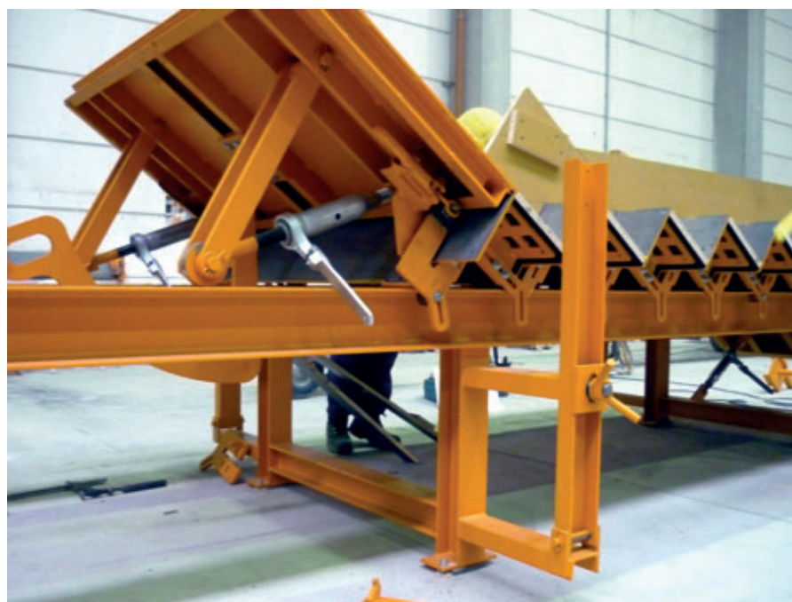
Fig. 5: Vista detallada: ajuste de la pendiente del rellano superior
