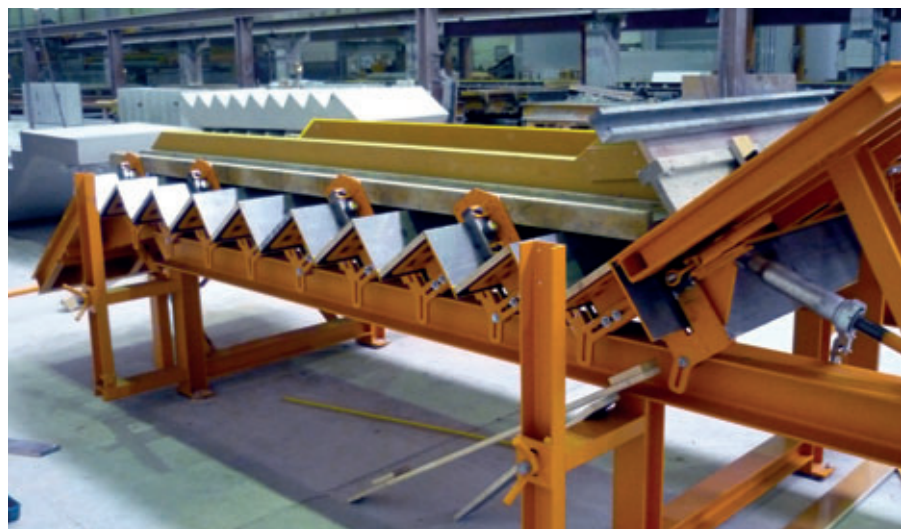
Fig. 2: Fabricación de escaleras estándar
