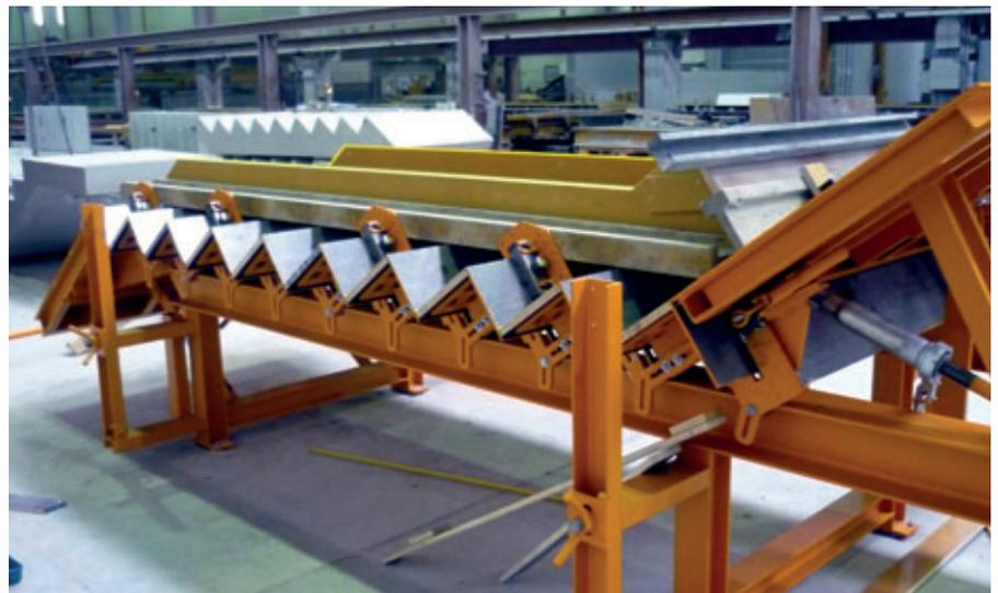
Abb. 2: Fertigung von Standardtreppen
