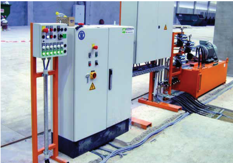
Пульт управления с системами контроля за гидравликой и вибраторами
