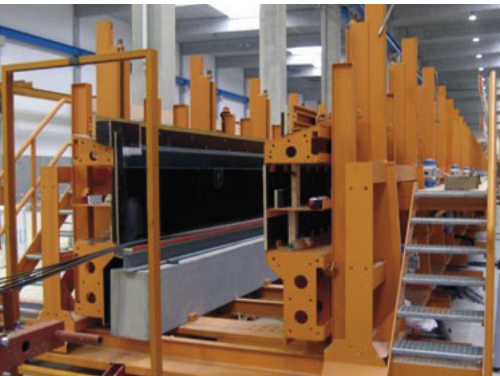
Szalunek z dodatkowymi elementami formującymi do produkcji wiązarów.
