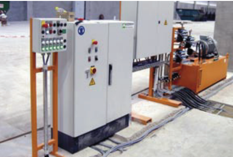
Stanowisko obsługi z panelem sterowania dla układu hydraulicznego i wibratorów.
