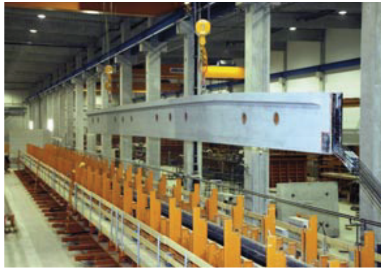
Wymywanie wiązara dla dachu dwuspadowego.
