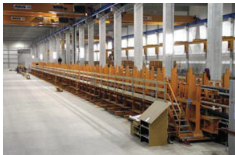
Wygląd całego szalunku uniwersalnego o długości 99 m.
