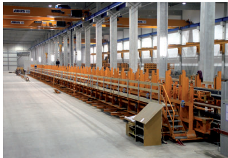
Vista global del encofrado universal de 99 m de largo
