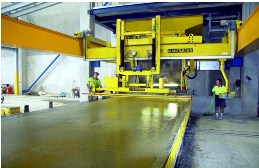
Бетоноукладчик с затирочным валом
