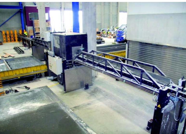
Устройство чистки форм с устройством транспортировки
