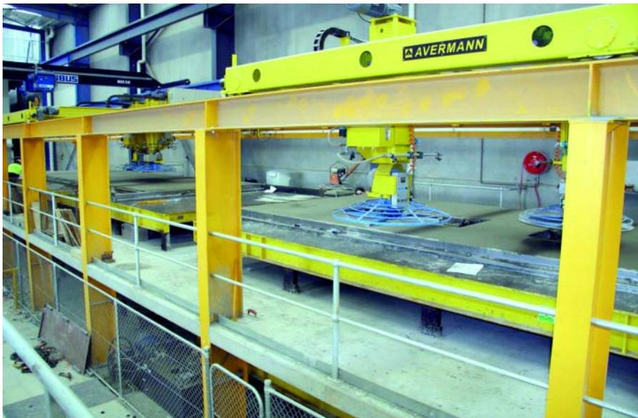
Участок шлифования с двумя шлифующими устройствами
