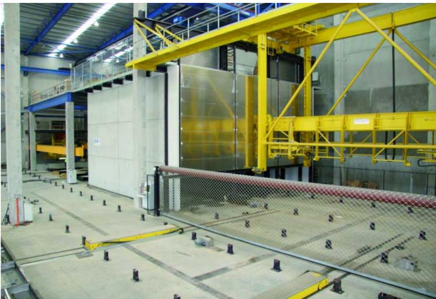
Камера тепловлажностной обработки с транспортно-складской системой
