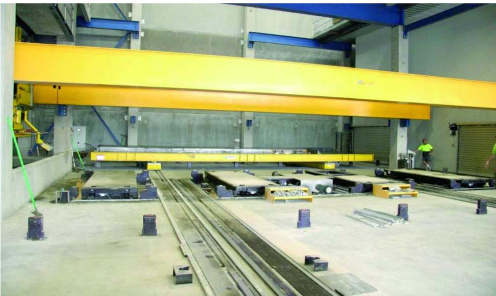
Бетоноукладчик и вибростенд
