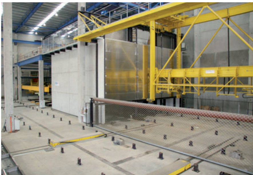
Cámara de curado con dispositivo de servicio de estantes
