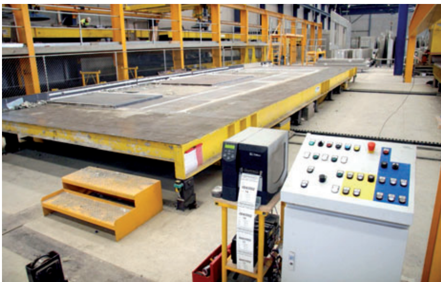
Estación de volteo con panel de mando e impresora de etiquetas
