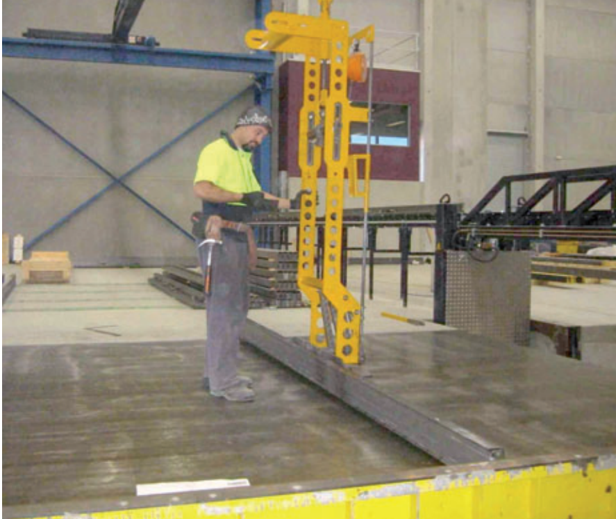
Equipo de manejo para los encofrados laterales
