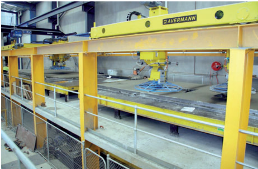
Estación de alisado con dispositivo de alisado con aspas
