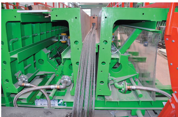
Комплект поставки включал стационарную опалубку для производства кровельных плит и межэтажных плит перекрытия (с Т-образным сечением), которая должна была устанавливаться на имеющемся стенде для натяжения арматуры общей длиной в 60 м, ...
