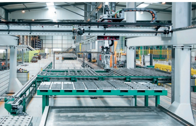
Robot szalunkowy i magazyn profili szalunkowych.
