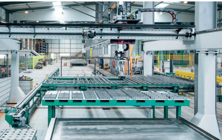
Schalungsroboter und Schalungsmagazin
