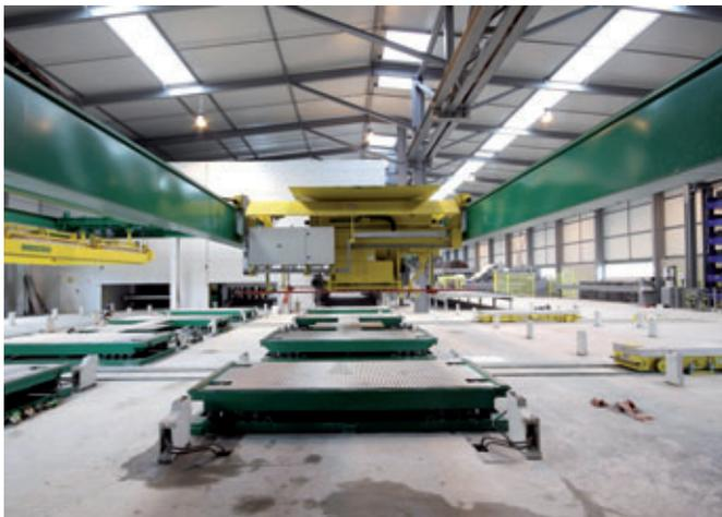
Compactador de vibración y estación de hormigonado con distribuidor de hormigón
