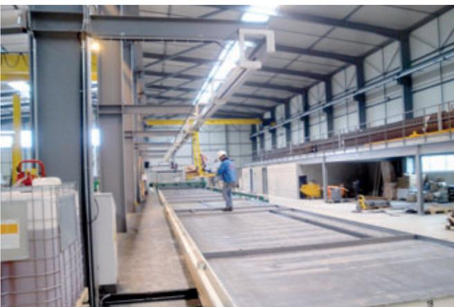
*Puesto de encofrado manual con el sistema de puesto de trabajo*
