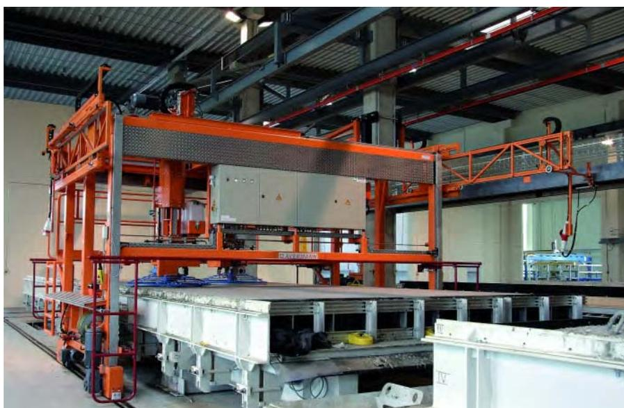
Контролируемая дистанционно затирочная установка с двумя выравнивающими элементами
