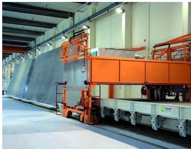
Установка для очистки, смазки и подготовки поверхности стола
