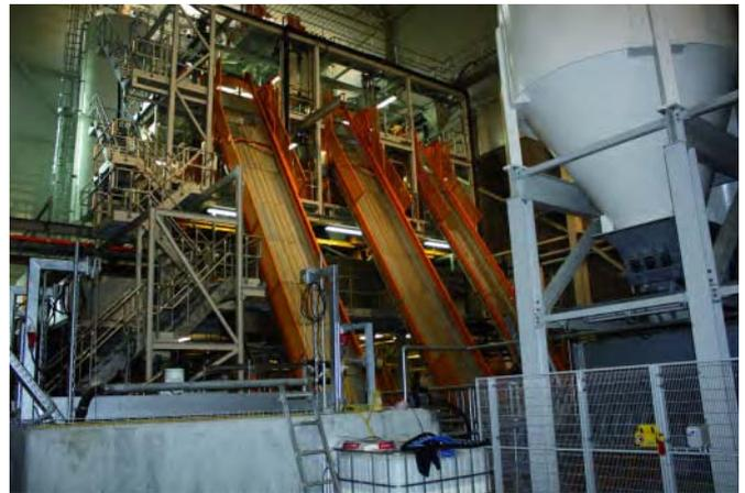
Транспортировка заполнителей к трем наклонным ковшевым элеваторам
