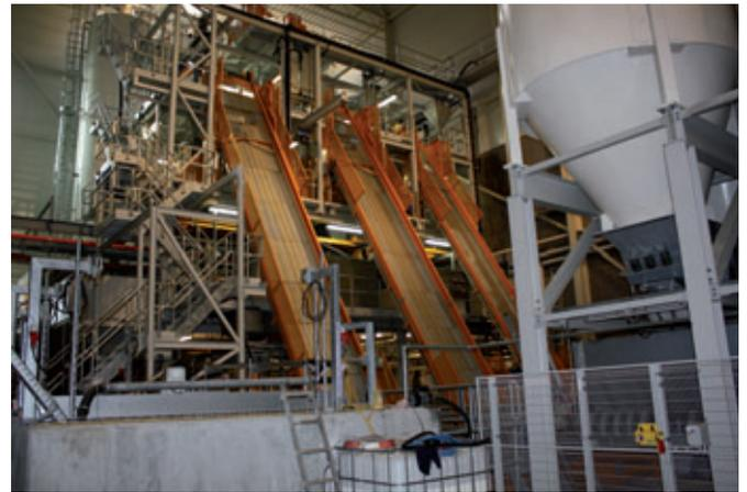
Remise des granulats au niveau des trois monte-charges à benne inclinés
