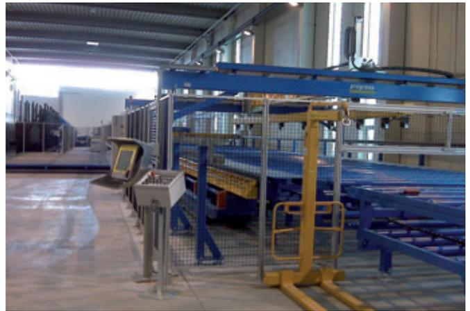
L'installation de soudage de treillis permet de produire des treillis de dimensions pouvant atteindre 6 m x 12 m
