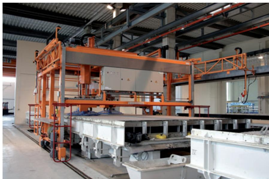
*Truelles mécaniques télécommandées par radio avec deux unités de lissage*
