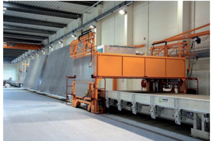
Machine de nettoyage / traçage / pulvérisation en position de base
