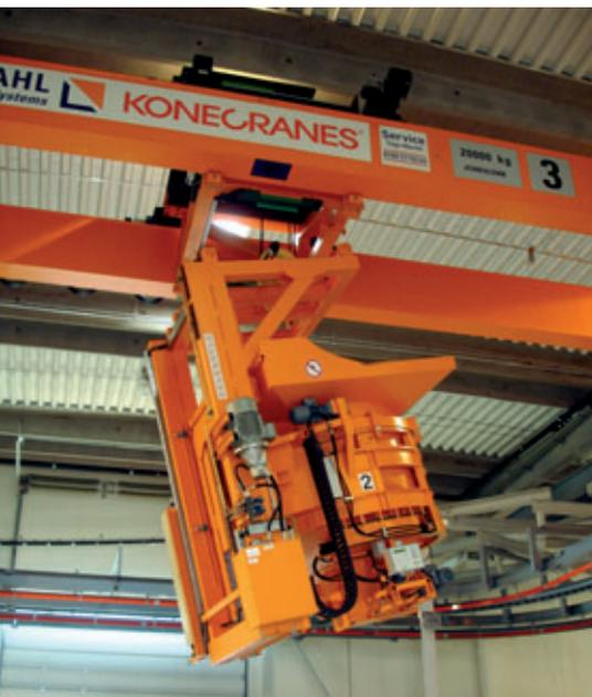
*Distributeur de béton lors du raccordement à la grue*
