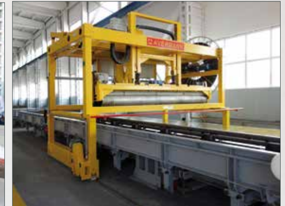
Blick in eine der beiden Fertigungshallen mit Kipptischen und Glättmaschine
