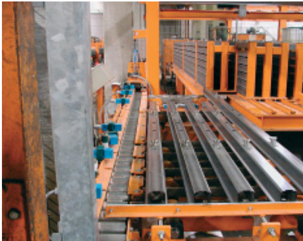
Rollenförderer für Schalungsmaterial mit Längen-Identifizierung
