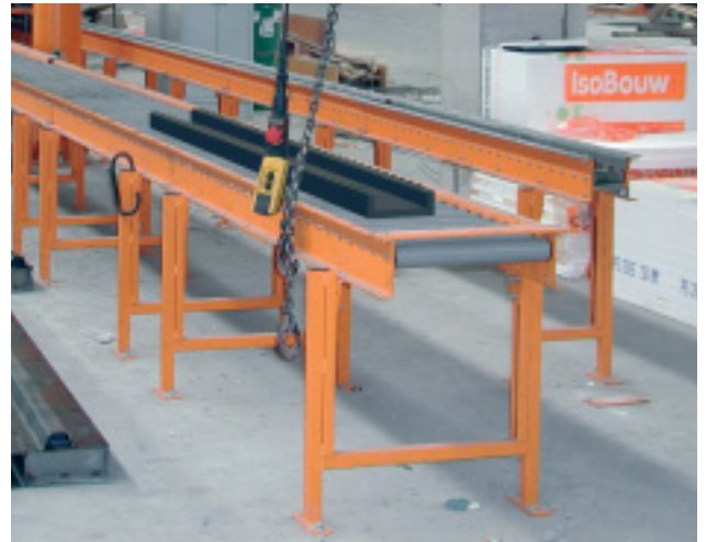
Rollenförderer für Transport von Schalungsmaterial
