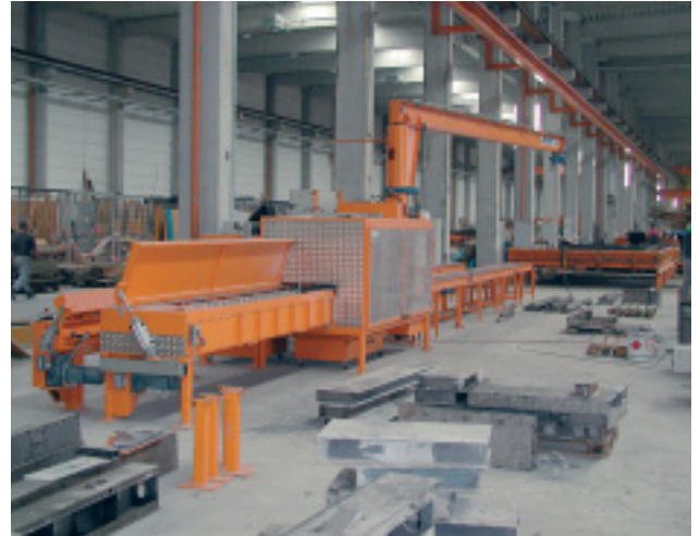
Reinigungsmaschine für Deckenplatten/ Doppelwandschalungen
