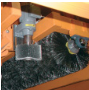
Detaildarstellung der Randschalungs- und der Flächenbürste
