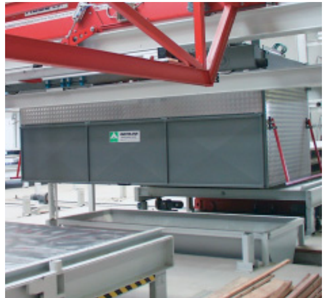
Reinigungsmaschine mit Brückenfahwerk
