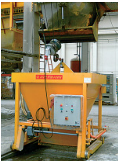
Betonierkübel mit elektromotorischem Fahrwerk
