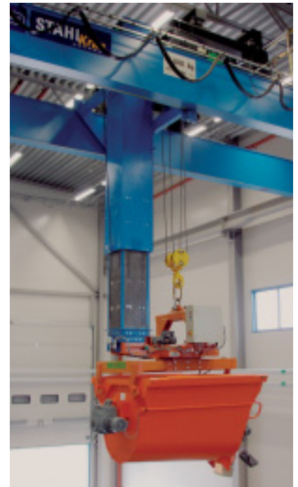
Betoniereinrichtung mit Kranstabilisator und Wechselbehälter
