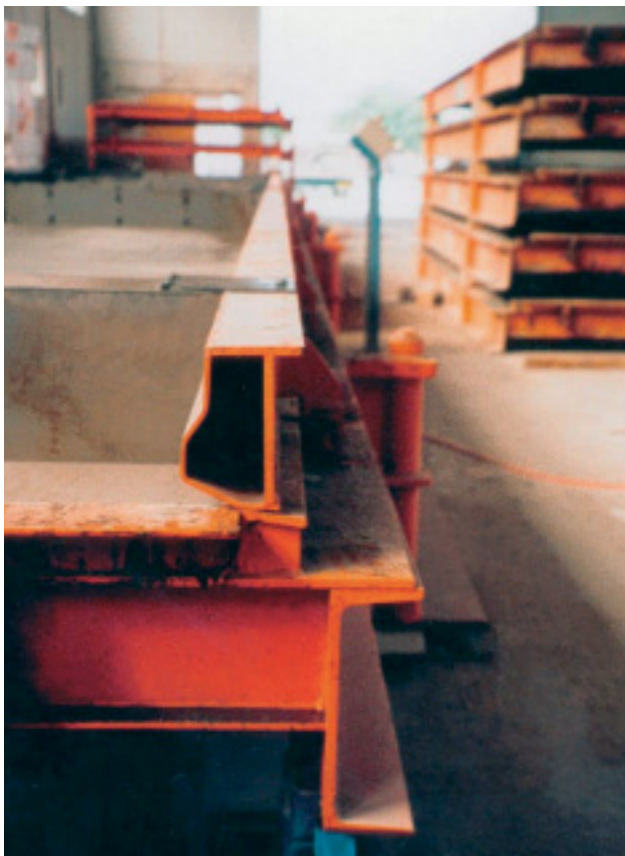
Schalung mechanisch abklappbar
