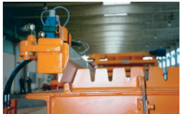
Hydraulisch hochfahrbare Spezialschalung
