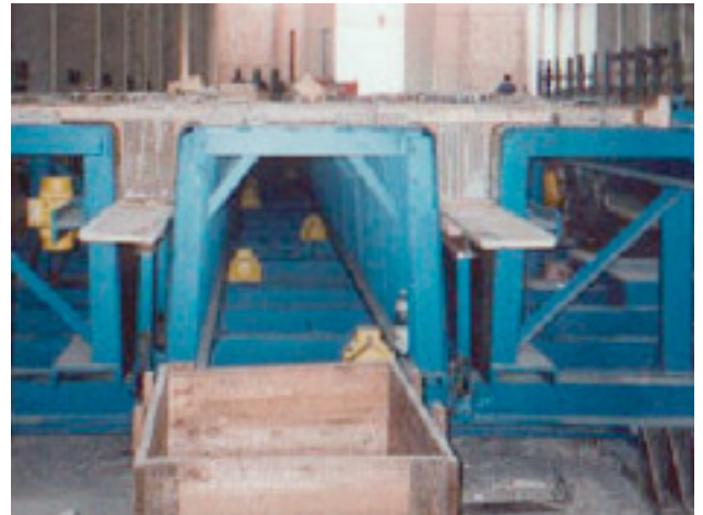
Hydraulisch verstellbare TT-Schalung mit mechanischer Bodenhöhenverstellung
