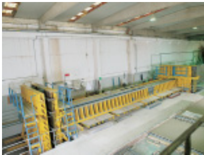
Zwillingsstützenschalung mit Fußschalung
