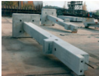
Stütze mit angeformten Fundamentfuß
