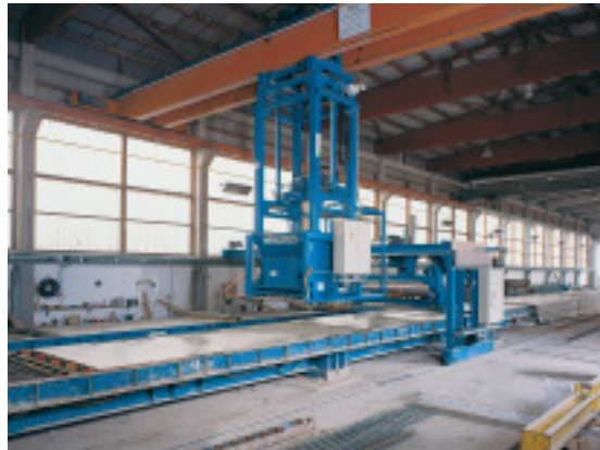
Betonverteiler am Kran (BV)
