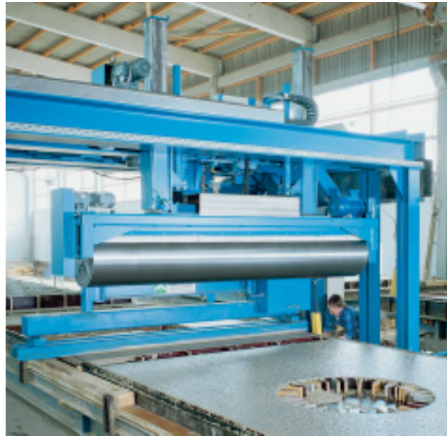
Kombination von Abziehvorrichtung + Vibrationsglättwalze
