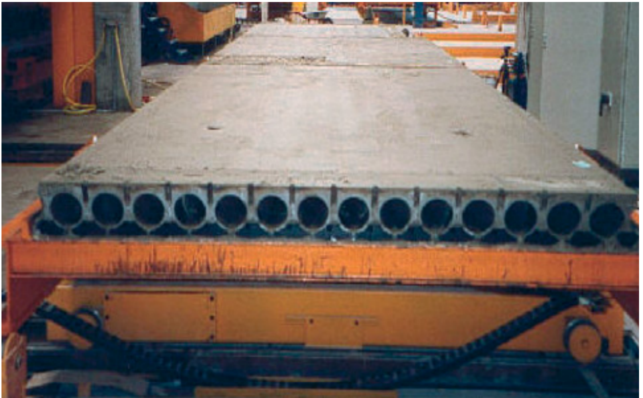
Nach Ausfahrt aus der Rohrziehanlage
