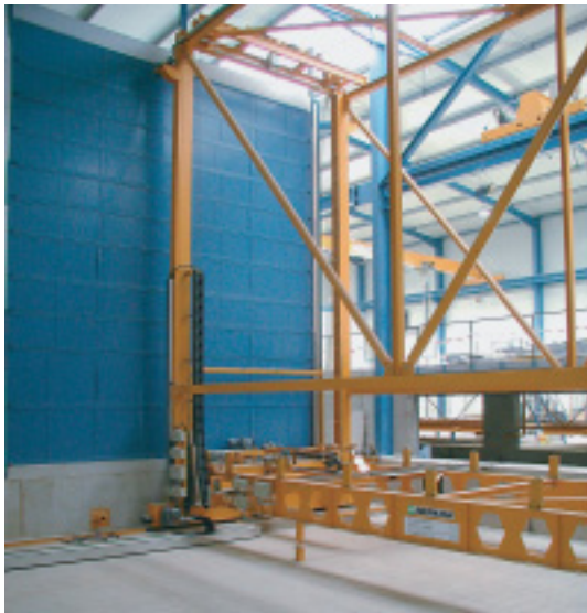
HBA in einer Grube angeordnet mit geschlossener Härtekammer
