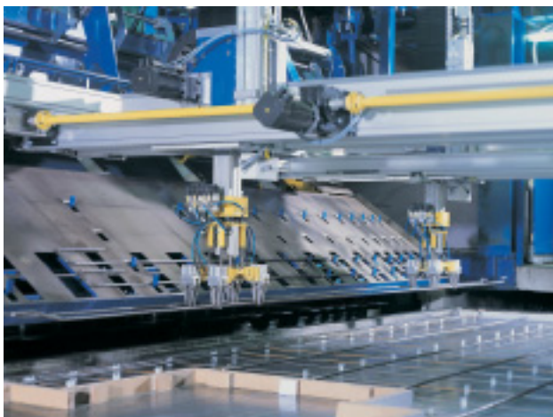
Automatische Bewehrungssysteme mit Stahlverlegeroboter für Längs- Querstäbe und Gitterträger (für Elementdecken, Doppelwand und Massivwand)
