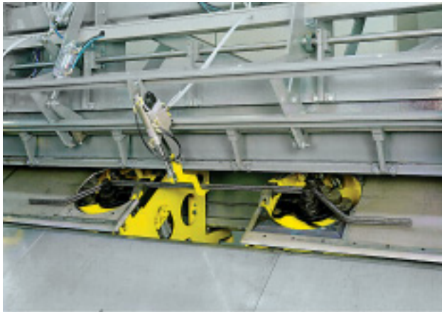
Rotorricht- und Schneidemaschinen für Betonstahl vom Coil ( \varnothing 6mm bis \varnothing 16mm), mit schnellem Drahtdurchmesserwechsel
